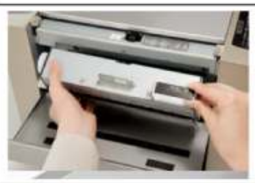
Die Schneid- Rill- oder Perforierkassette kann sehr einfach entnommen und gewechselt werden!
