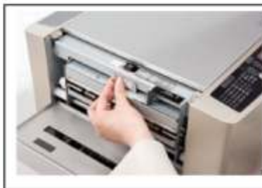
Die Schneid- Rill- oder Perforierkassette kann sehr einfach entnommen und gewechselt werden!
