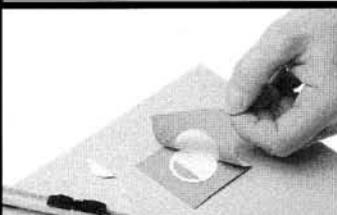
Prägoplast knapp ringsum beschneiden. Überschüssiges Prägoplast entfernen.
