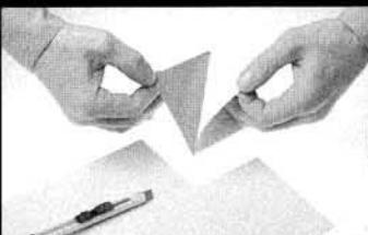
Ein Stück Prägoplast abschneiden und rückseitiges Schutzpapier entfernen.
