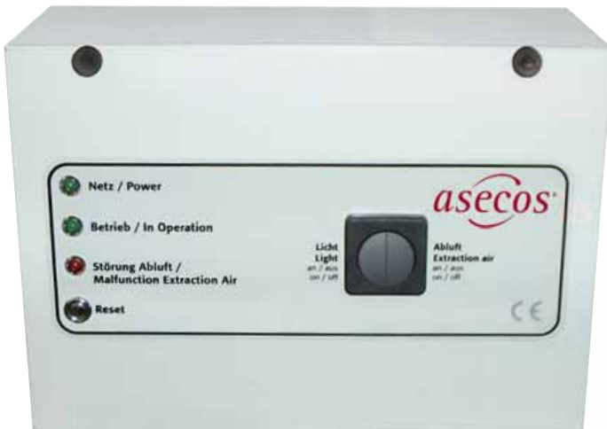
Abb.: Im Lieferumfang enthaltener Schaltkasten inkl. Überwachungselektronik muss außerhalb der Ex-Zone montiert werden und ist bauseitig mit dem Gefahrstoffarbeitsplatz zu verkabeln.
